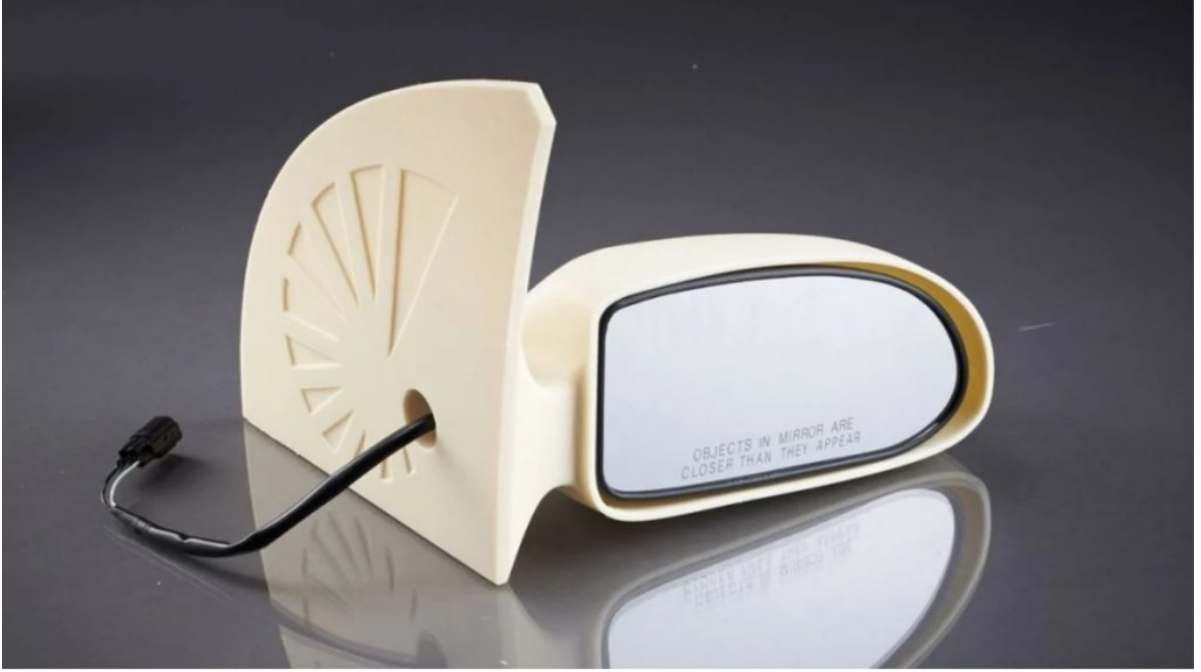
ASA filamentten üretilen bir araba aynası
