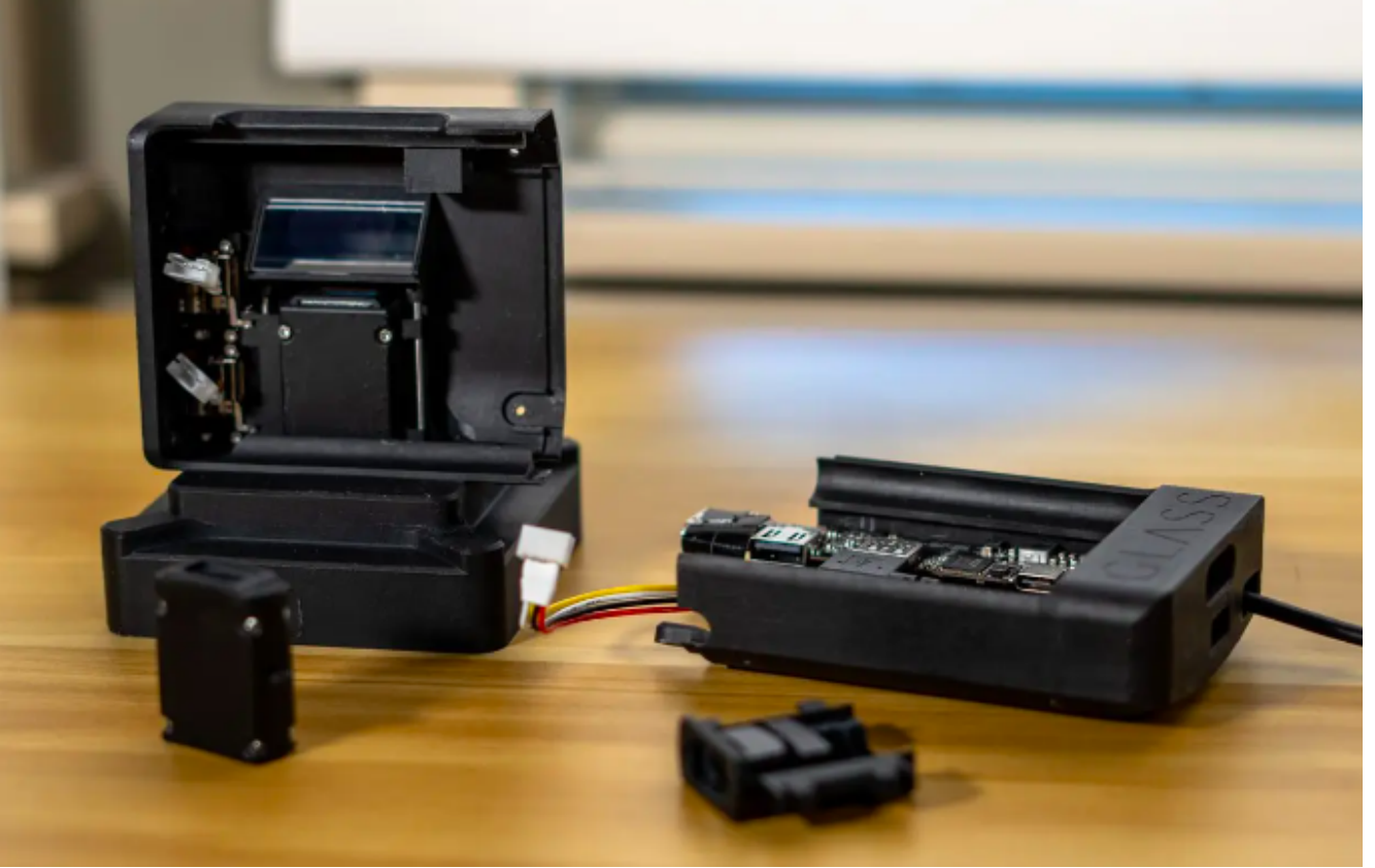
3D baskı Cam Görüntüleme prototip kamera kasası ve lens yuvalarının bileşenleri.
