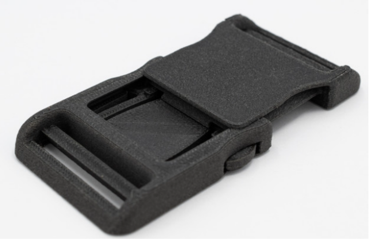
Fortis3D, PK-GF20 ile 3D baskılı parça
