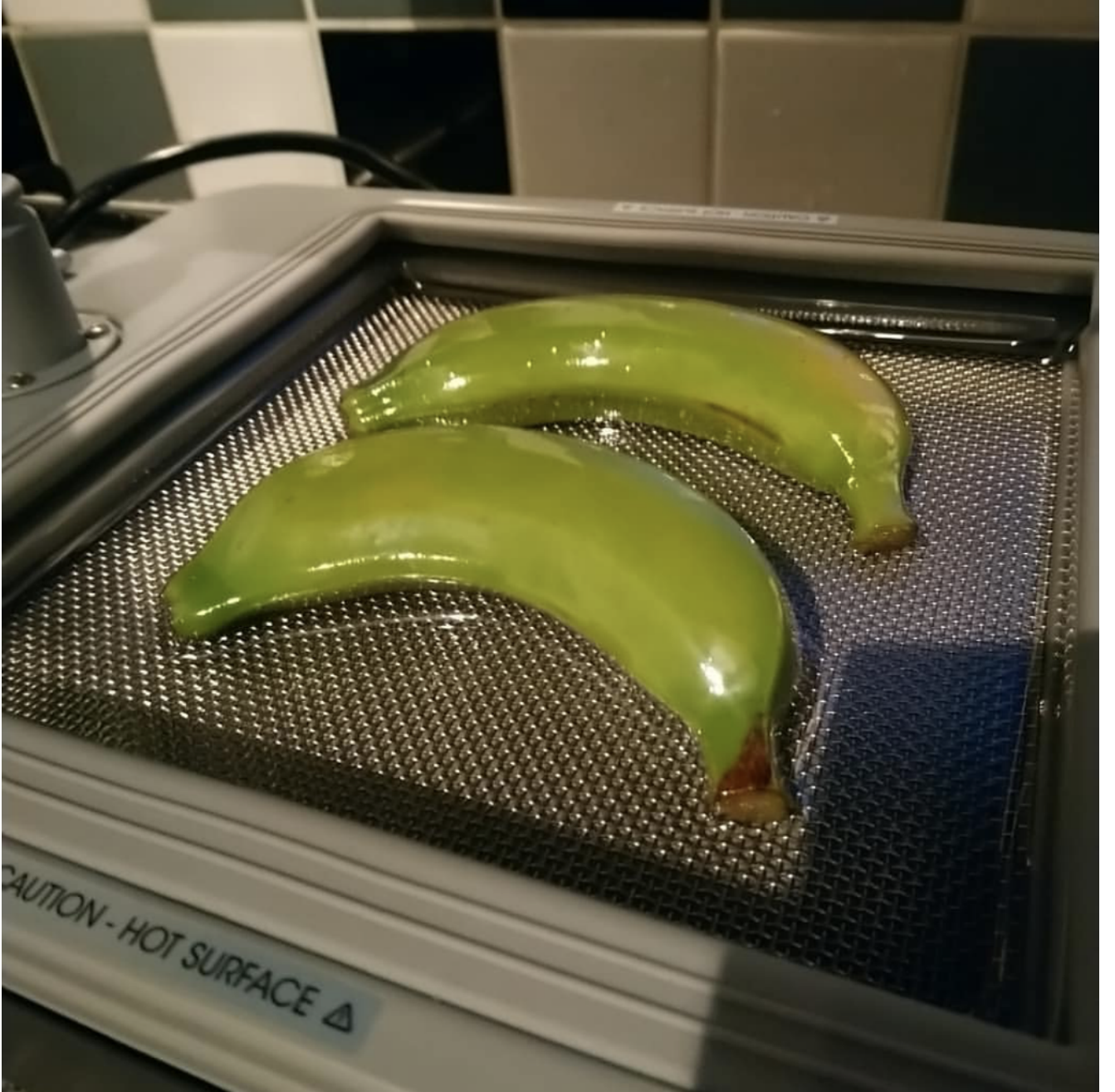
FormBox ile üretilen muz kalıpları
