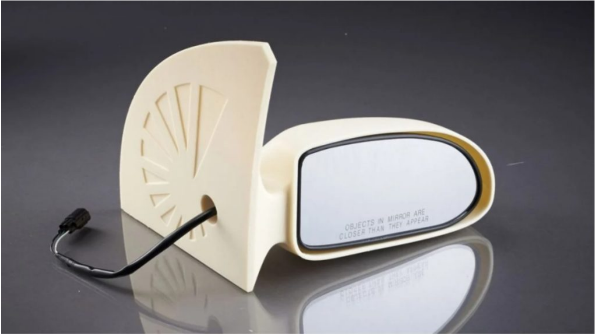
ASA filamentten üretilen bir araba aynası
