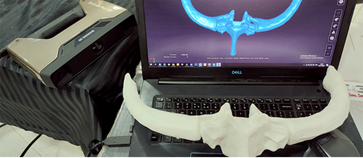
EinScan Pro HD ile heykel parçalarının 3D tarama işlemi
