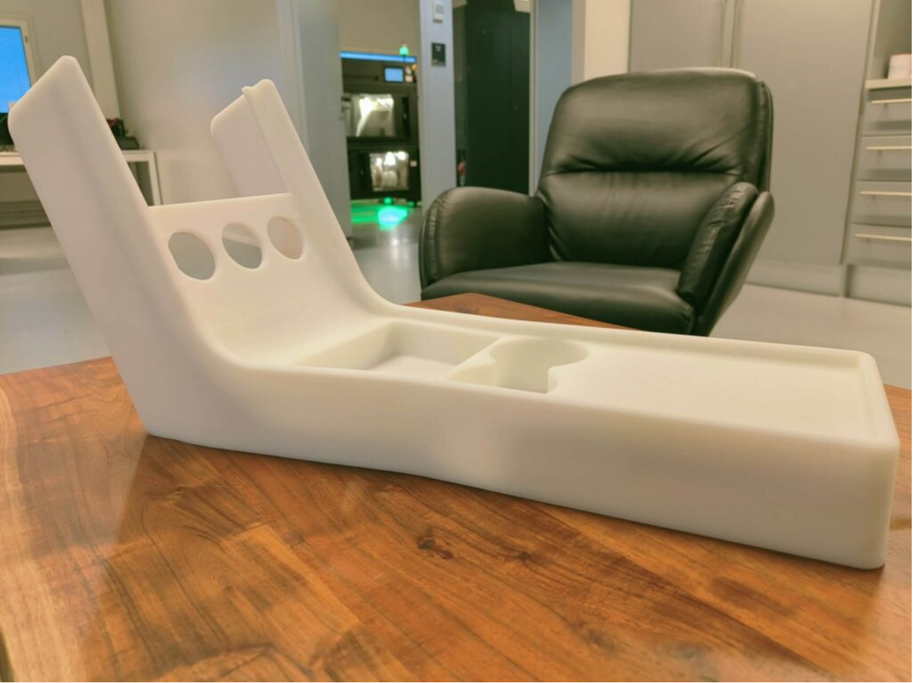
ABS ile basılmış otomotiv orta konsol prototipi. Boyut: 550 x 250 x 200 mm. Baskı süresi: 24 saat. Ağırlık: 1,8 kg.
