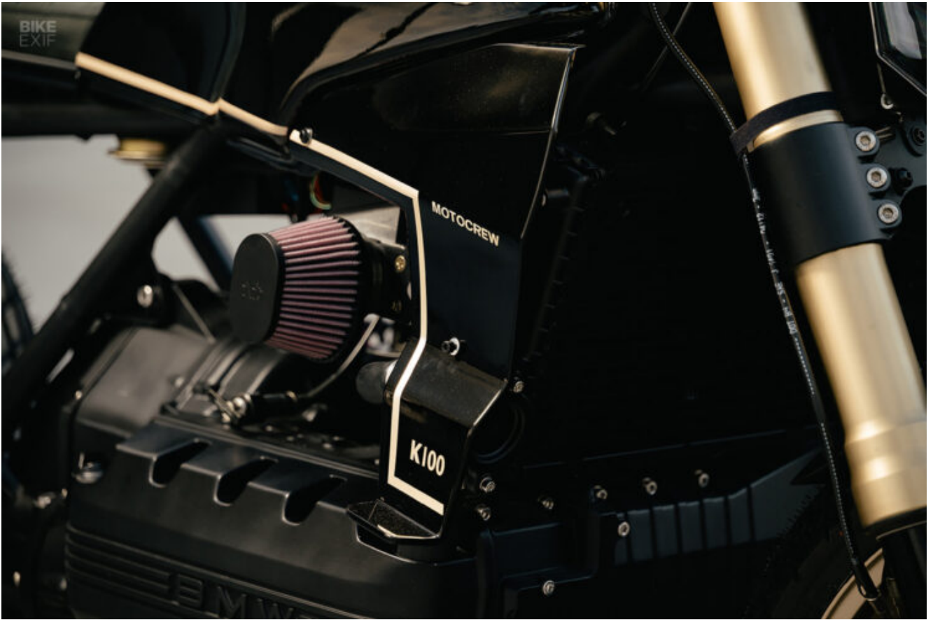
3D baskılı hava girişlerine takılı K&N hava filtresi.
