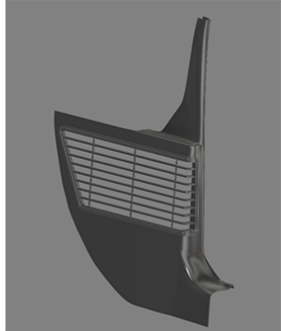
Panelin ve ayak boşluğunun 3B tarama işlemi
