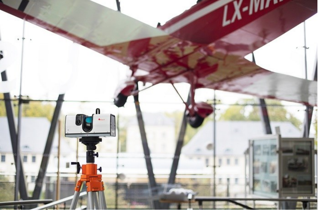
Sabit 3D tarayıcı ile büyük nesneleri tarama
